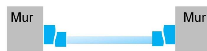
La fenêtre est posée sur l'épaisseur du mur, cette pose est recommandée pour les murs en pierre. Cette fenêtre est facile à poser, elle est compatible avec tous les types d'isolation. En revanche à terme la menuiserie peut bouger et l'étanchéité n'est pas la plus performante.
