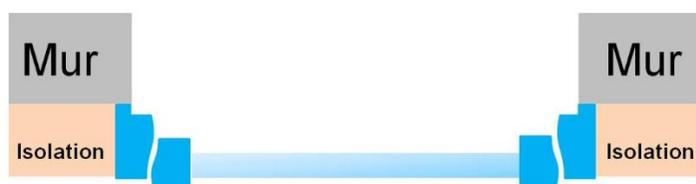
Idéale sur une construction neuve, elle est intégrée à l'isolation, ce qui garantit la performance, la surface de vitrage est maximale.
