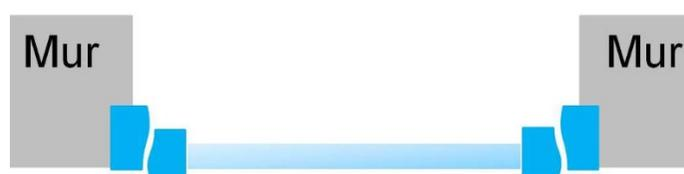
Souvent employée en rénovation, la fenêtre est posée dans l'ancien mur, ce qui garantit son étanchéité, la fenêtre est réalisée sur mesure. Compatible avec l'isolation par l'intérieur ou l'extérieur. Des finitions importantes sont à prévoir
